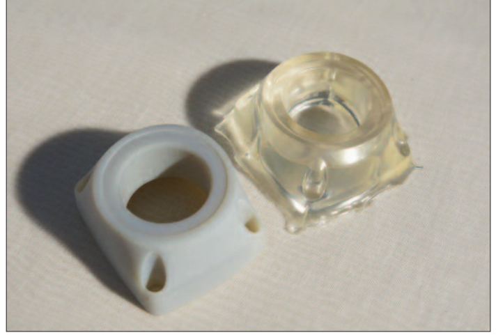
Original (Sinterprozess) und Kopie (Epoxyd-Gießharz), erzeugt mit RapidVacMold
